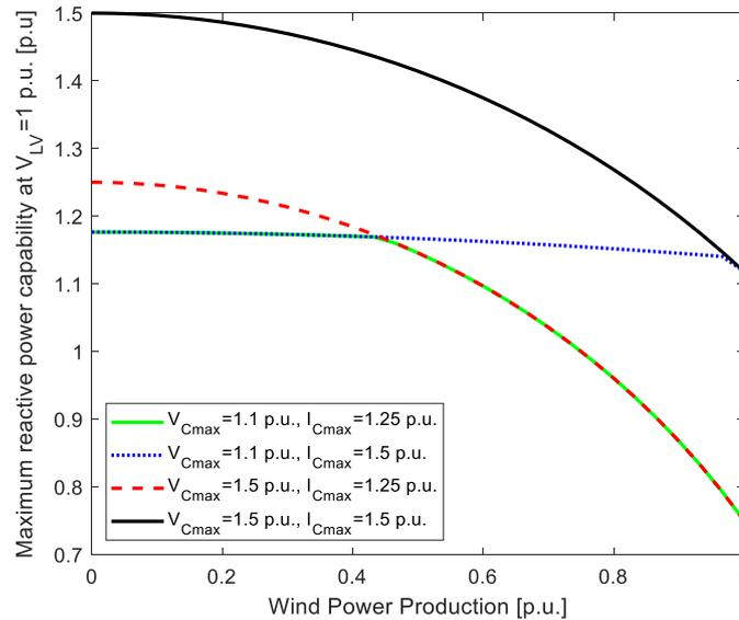
FIGURE 18 MAXIMUM REACTIVE POWER CAPABILITY OF THE WIND TURBINE FOR DIFFERENT CONVERTER SIZE
