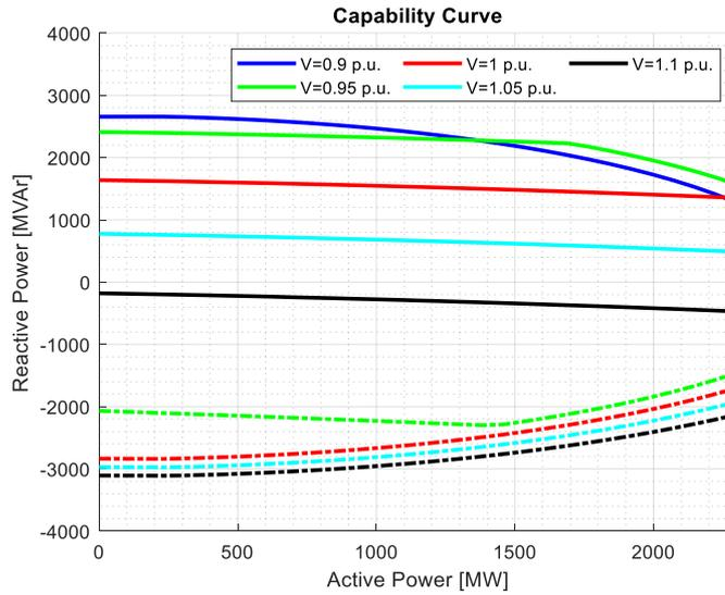
FIGURE 1 REACTIVE POWER CAPABILITY OF WIND TURBINE
