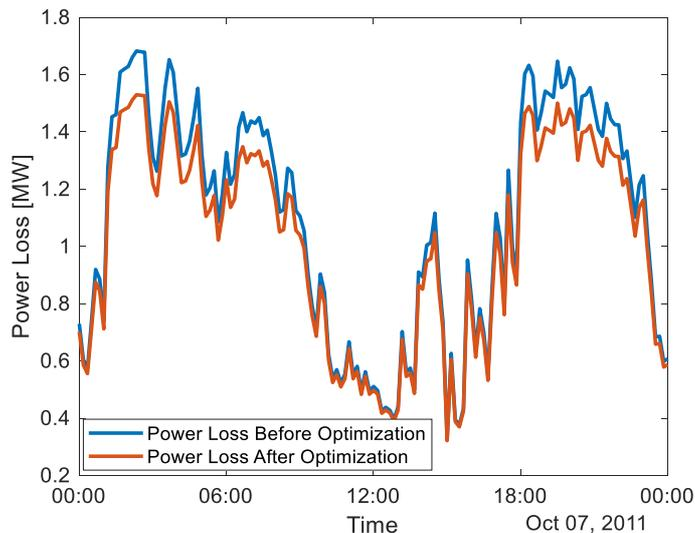
FIGURE 6 POWER LOSS BEFORE AND AFTER OPTIMIZATION FOR THE REPRESENTATIVE HIGH WIND DAY
