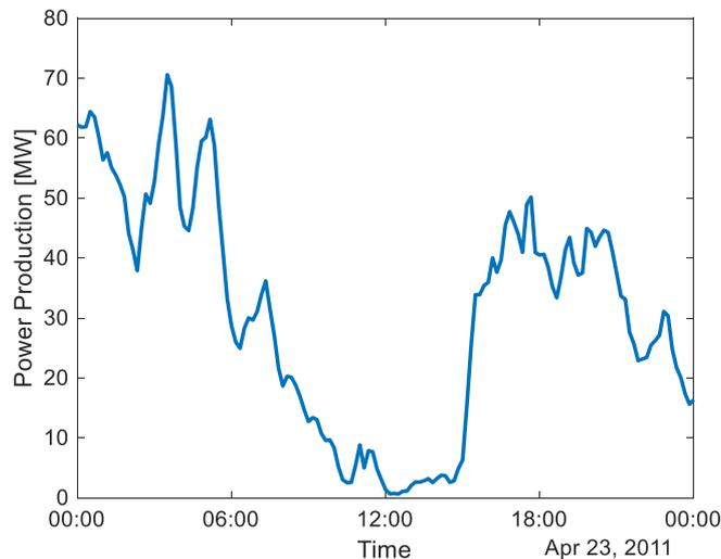
FIGURE 10 WIND POWER PRODUCTION IN REPRESENTATIVE MEDIUM WIND DAY
