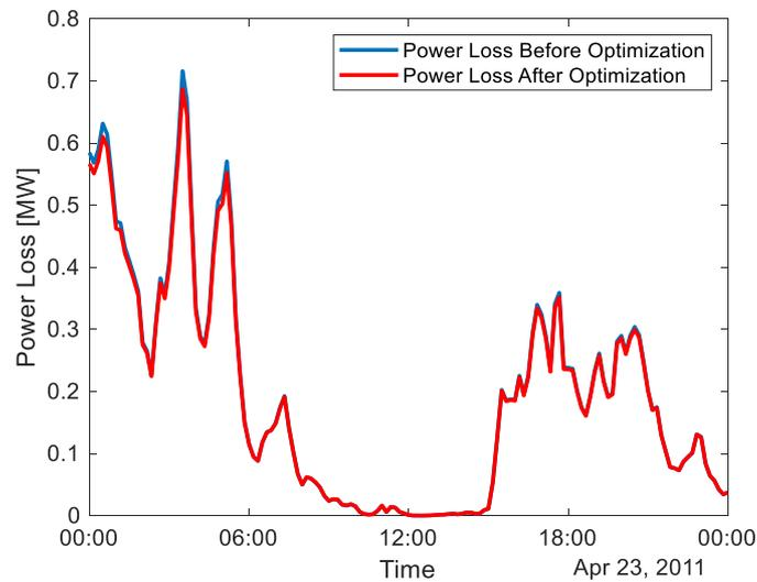
FIGURE 11 POWER LOSS BEFORE AND AFTER OPTIMIZATION FOR THE REPRESENTATIVE MEDIUM WIND DAY
