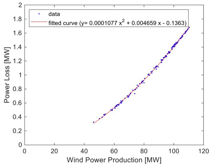
FIGURE 8 CURVE FITTING FOR ACTIVE POWER LOSS AGAINST ACTIVE POWER PRODUCTION DURING HIGH WIND SCENARIO
