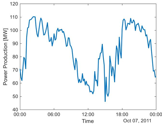
FIGURE 5 WIND POWER PRODUCTION IN REPRESENTATIVE HIGH WIND DAY
