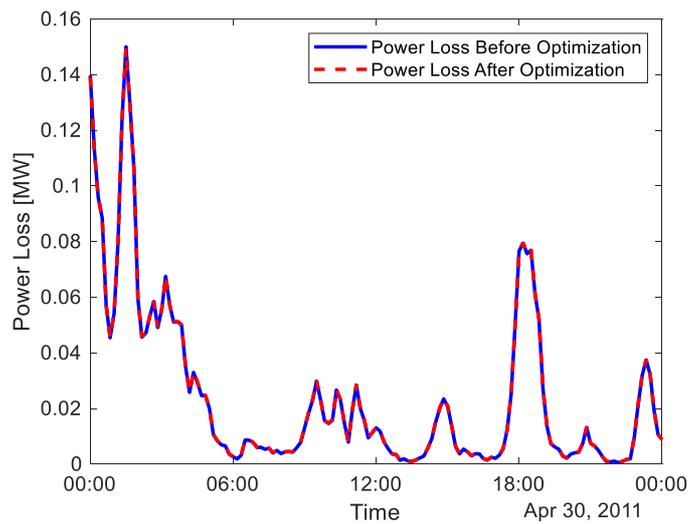
FIGURE 16 POWER LOSS BEFORE AND AFTER OPTIMIZATION FOR THE REPRESENTATIVE LOW WIND DAY
