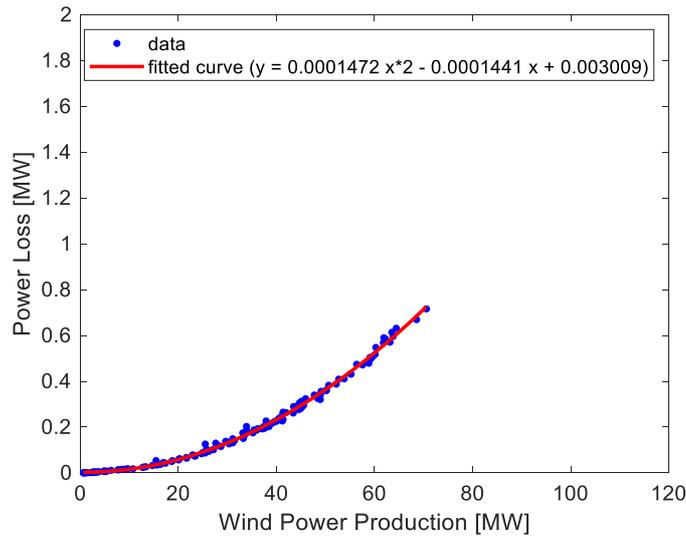
FIGURE 13 CURVE FITTING FOR ACTIVE POWER LOSS AGAINST ACTIVE POWER PRODUCTION DURING MEDIUM WIND SCENARIO
